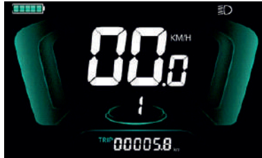
Şekil 5-4 Arka ışık (Backlight) ekran arayüzü
