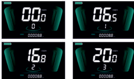
Şekil 5-5 Pedal Destek (PAS) seviye ekran arayüzü
