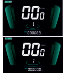
(Şekil 7-2 Seyahat mesafesi (Trip Odometer) sıfırlama ekran arayüzü)
