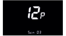
(Şekil 6-12 Pedal destek gücü ayar ekranı)
