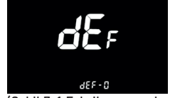
(Şekil 7-1 Fabrika varsayılan parametre ayarlarını geri yükleme ekran arayüzü)
