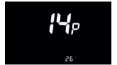
(Şekil 6-14 Kontrolör akım sınırı ayar ekranı)
