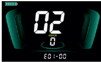
(Şekil 5-7 Hata kodu ekran arayüzü)
