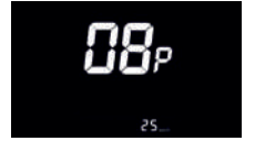
(Şekil 6-8 Hız sınırı ayar ekranı)
