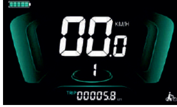
Şekil 5-3 Yürüyüş destek modu ekran arayüzü
